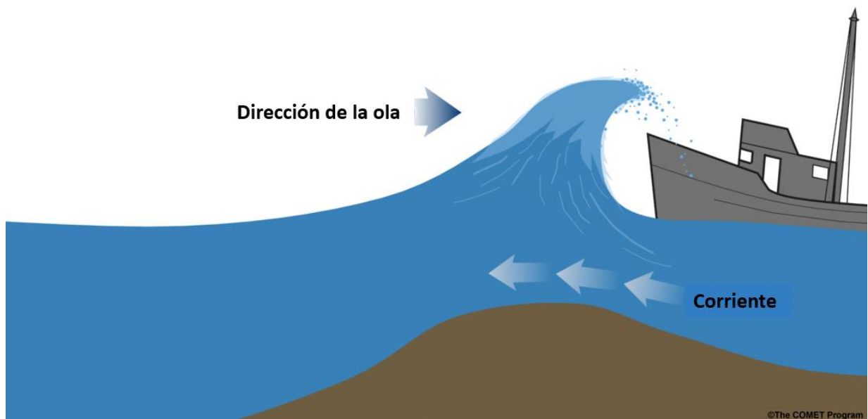
Figura 3. Esquema simplificado del efecto Doppler que experimenta el oleaje al transitar por una zona de bajos, o en aguas someras, cuando una corriente de cierta intensidad tiene sentido contrario, reforzando la altura y la pendiente de las olas en el proceso de rotura. Fuente: módulos COMET ( http://www.comet.ucar.edu ).
